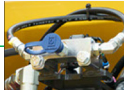
Port pengecekan tekanan oli hidrolik
